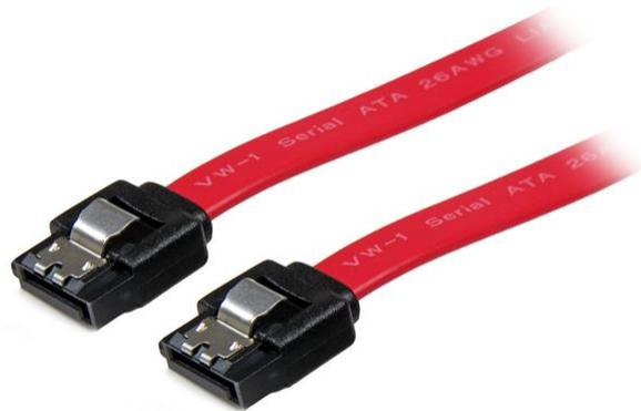
Das SATA-Kabel LSATA12 verfügt über zwei einrastbare 7-polige Datenaufnahmen und unterstützt die volle SATA 3.0-Bandbreite von bis zu 6 Gbit/s bei Verwendung mit SATA 3.0-konformen Laufwerken.
