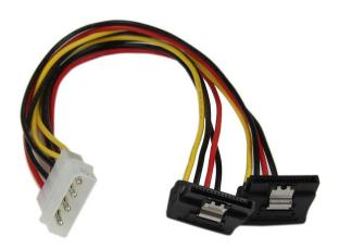
Das LP4 Molex-auf-einrastendes, rechtsgewinkeltes Dual SATA-Strom-Splitter-Kabel PYO2LP4LSATR ist mit zwei seriellen ATA-Strombuchsen und einem LP4-Stecker versehen und bietet eine zuverlässige Lösung für die Stromversorgung von zwei SATA-Laufwerken über einen einzigen LP4-Anschluss an die Stromversorgung des Computers.
