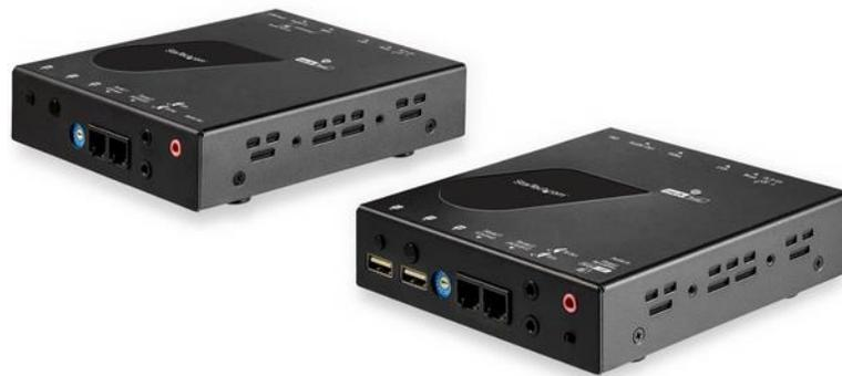
Mit diesem HDMI-KVM-Extender-Set können Sie per Tastatur, Maus und Monitor jeden Computer über Ihr IP-fähiges lokales Netzwerk (LAN) fernsteuern. In Kombination mit einem KVM-Switch kann der 4K HDMI Extender über LAN kann von mehreren Computern verwendet werden. Der Extender verfügt über vier USB-Anschlüsse, über die Sie zusätzlich zu Tastatur und Maus weitere USB-Geräte anschließen können.
