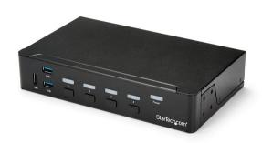
Mithilfe dieses 4-Port-USB 3.0-HDMI®-KVM-Switches können Sie vier HDMI-Computer mit nur einem Monitor, einer Tastatur und einer Maus steuern. Der KVM ist auch mit 3,5-mm-Audio und einem integrierten 3-Port-USB 3.0-Hub ausgestattet.
