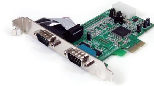
Mit der seriellen PCI Express-Karte PEX2S553 können Sie einen PCI Express-Steckplatz in 2 serielle RS232 (DB9)-Ports verwandeln. Diese 2-Port-Seriell-Adapterkarte basiert auf einem systemeigenen Einzelchip-Design (kein Brückenchip), mit dem Sie die vollen Fähigkeiten von PCI Express (PCIe) nutzen und gleichzeitig die CPU-Last im Vergleich zu herkömmlichen seriellen Karten um bis zu 48 % reduzieren können.
