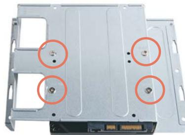
5. Setzen Sie die 3,5" Festplatte auf die Halterung und befestigen Sie sie seitlich mit Schrauben.
