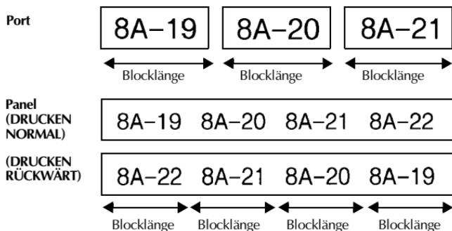
Nach Auswahl des Label-Typs **PORT** oder **PANEL** können Sie die Länge der einzelnen Textblöcke bzw. Etiketten angeben und eine Rahmenart auswählen.
