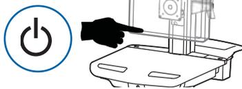
2 Stecken Sie den Netzstecker in eine geeignete Netzsteckdose, um die Batterie vollständig auf 100% aufzuladen (alle LEDs auf dem Bedienfeld leuchten auf). Vor dem Lagern muss die Stromversorgung voll aufgeladen sein!
