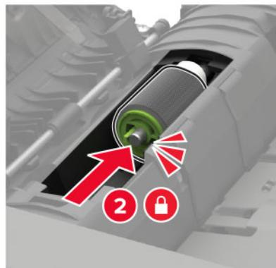
**9** Setzen Sie die Abdeckung der ADZ-Trennrolle ein, bis sie mit einem *Klick* einrastet.
