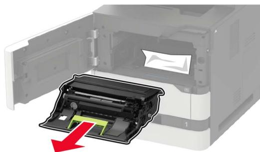
**Warnung—Mögliche Schäden:** Setzen Sie den Fotoleiter nicht länger als zehn Minuten direktem Licht aus. Wenn es zu lange dem Licht ausgesetzt ist, kann dies zu Problemen mit der Druckqualität führen.
