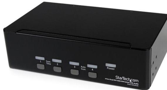
Mit dem 4-Port Dual DVI USB KVM-Switch SV431DD2DUA können bis zu vier PCs mit jeweils zwei DVI Videoausgängen zwei Monitore, ein Mikrofon und einen Satz Lautsprecher, eine Tastatur und Maus sowie zwei weitere USB-Peripheriegeräte gemeinsam verwenden.
