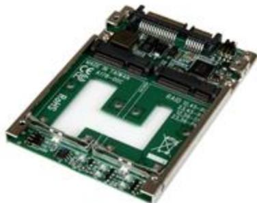
Erhöhen Sie drastisch die Systemleistung, indem Sie einer 2,5-Zoll-SATA-HDD-Anwendung mit dem mSATA-auf-SATA-Adapter 25SAT22MSAT ein duales mSATA SSD-RAID-Array hinzufügen.
