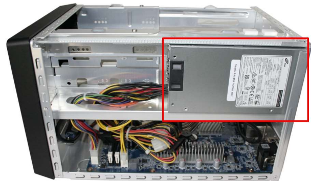
Verwendung des Netzteils FSP300 in einem Shuttle XPC cube SH610R4
